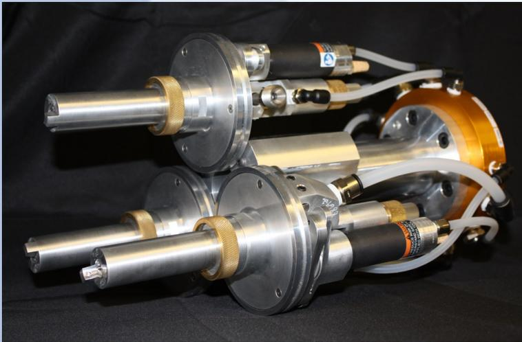
**3 pequeñas Pistolas rotatorias sobre un soporte sencillo con cabezal de desconexión rápida, ahorra tiempo en cambios de color y evita residuos.**
